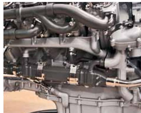
Теплообменник ОГ смонтировали сбоку блока, под выпускным коллектором
