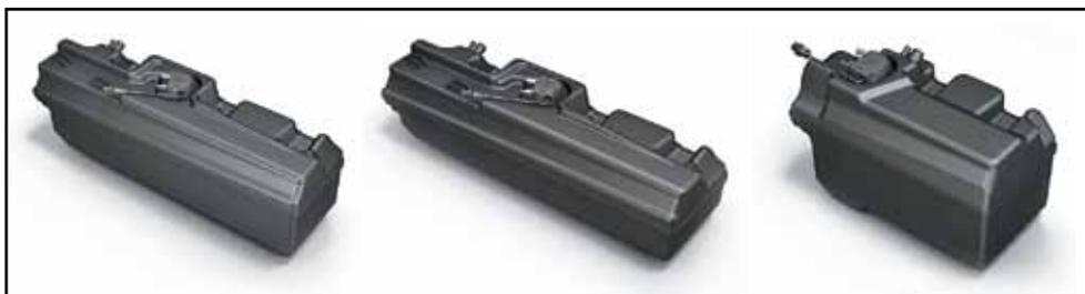
**Эти пластмассовые резервуары под мочевины сделаны для их размещения внутри рамы. Scania стала первым производителем, применившим такое решение**
